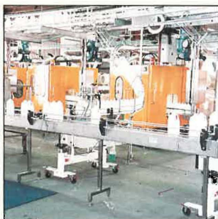
AKEI 塑料吹瓶機全自動生產線 AKEI fully automatic blow moulding production line
